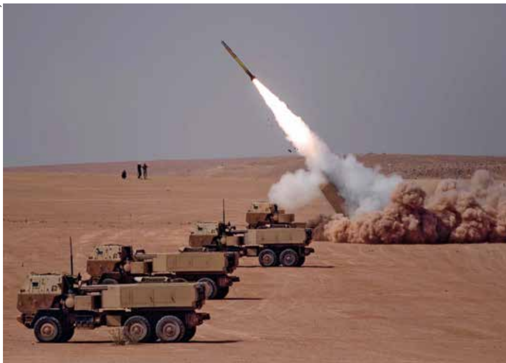
Das US High Mobility Artillery Rocket System HIMARS aus der MLRS-Familie hat eine Reichweite von bis zu 300km
