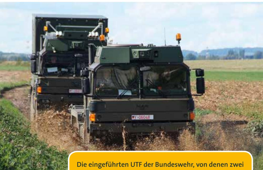
Die eingeführten UTF der Bundeswehr, von denen zwei in der F&T-Studie InterRoK für den teilautomatisierten Konvoi verwendet werden
