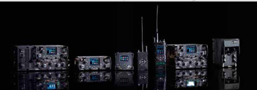
*Die Software Defined Radio (SDR)-Produktfamilie E-LynX™ ist eine moderne Funkgerätfamilie für taktische Einsätze. Mit richtungsweisenden Fähigkeiten, wie Mehrbandfähigkeit (30 MHz – 2,0 GHz), Mobile Ad-hoc Networking (MANET) und Breitbandwellenformen sowie NATO Kompatibilität erfüllt die E-LynX™ Familie jetzt schon die Anforderungen für D-LBO und ist auch für Luftfahrzeuge einsetzbar.*
