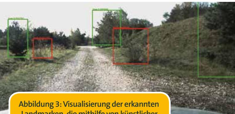
**Abbildung 3: Visualisierung der erkannten Landmarken, die mithilfe von künstlicher Intelligenz aus LiDAR-Punktwolken und Kamerabildern erkannt wurden: Bäume (grün), Büsche (rot)**
